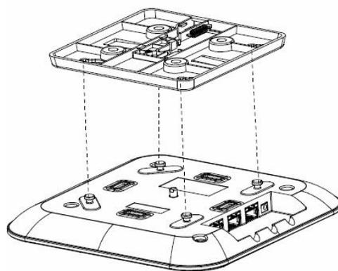
✚ 在主机卡入挂架前，请先安装好网线。
