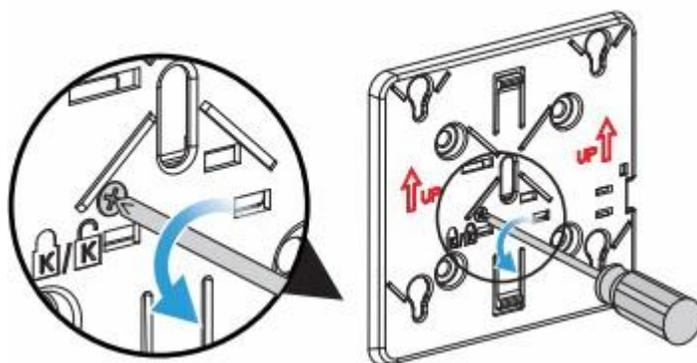
2) 将主机背后的挂扣对准挂架的扣孔，沿着挂架上的箭头反方向扣紧。
