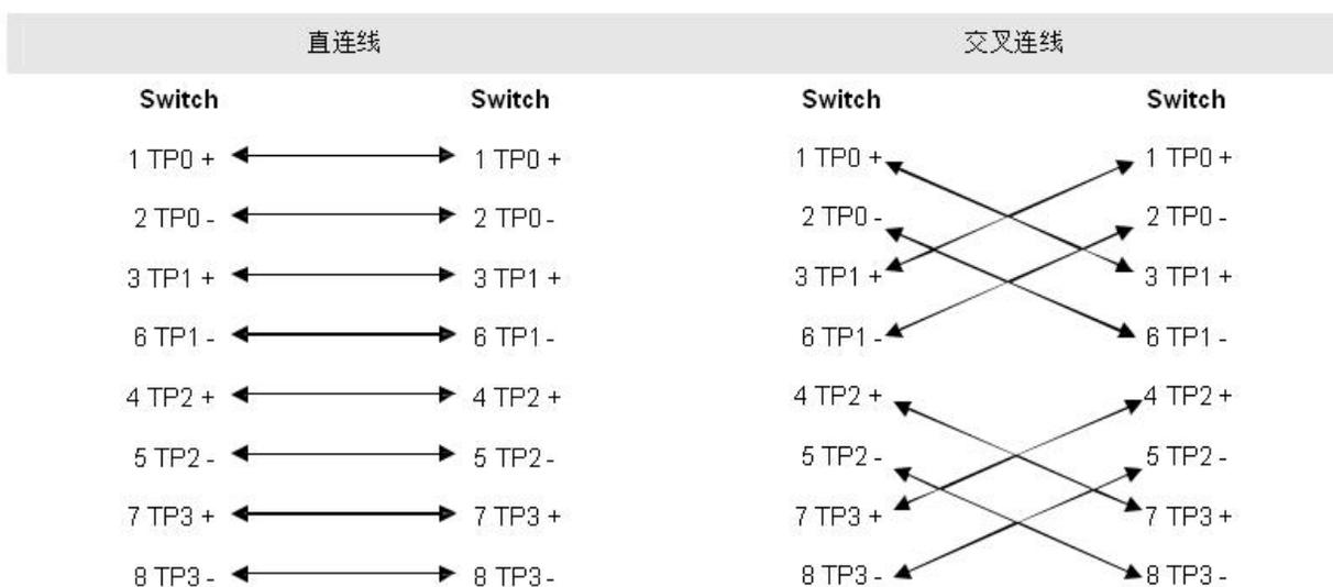
100BASE-TX/10BASE-T 除了可用以上规格的线缆相互连外，对于 10Mbps 可以用 100-ohm 3, 4, 5 类线，对于 100Mbps 联接用 100-ohm 5 类线相互连，最长都可支持 100 米的连接距离。以下是 100BASE-TX/10BASE-T 时的引脚信号定义。
