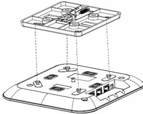
在主机卡入挂架前，请先安装好网线。
